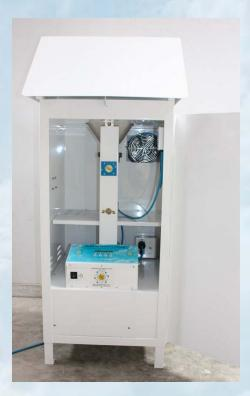
GAS-60810DT TSP Ambient Air Sampling System (8" x 10" Filter)
